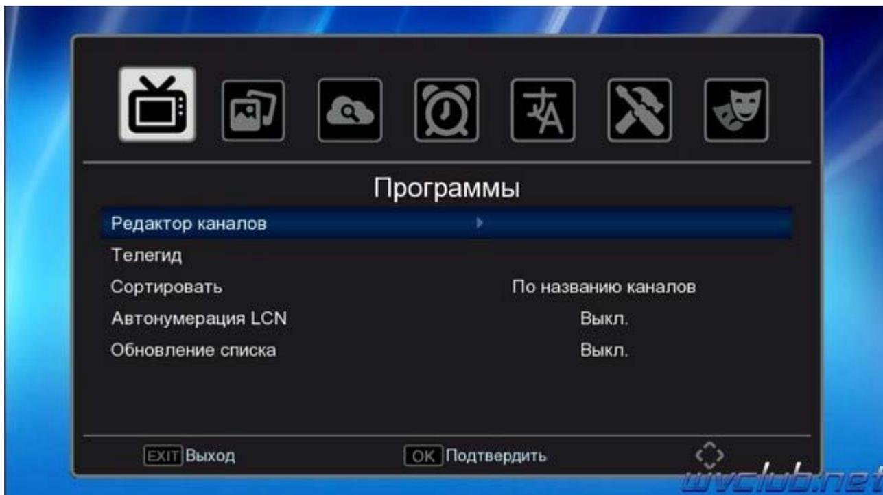
Если у вас был уже отсканирован список каналов, то заходим в редактор каналов, нажимаем кнопку ноль, все каналы выделяются крестиком на удаление и нажимаем **Exit**, на вопрос о подтверждении действий даём согласие.
